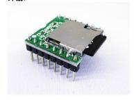
MK-157 専用コントローラボード(別売)に実装例(付属の8ピンソケッ トを使用して実装。直付けも可能):
