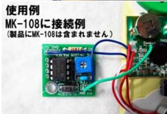
けし、その一方をMK-325のグラウンド端子(GNDと印字あり)。GNDと印字されている端子は2個ありますが、いずれか1つだけに接続します。
