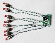
◆スピーカーへの電線の実装・・・・・適当なビニール電線(写真ではツイスト電線使用)を10cm程度に切断し、先端のビニール皮膜を3mm程度取り除き、予備ハンダします。
