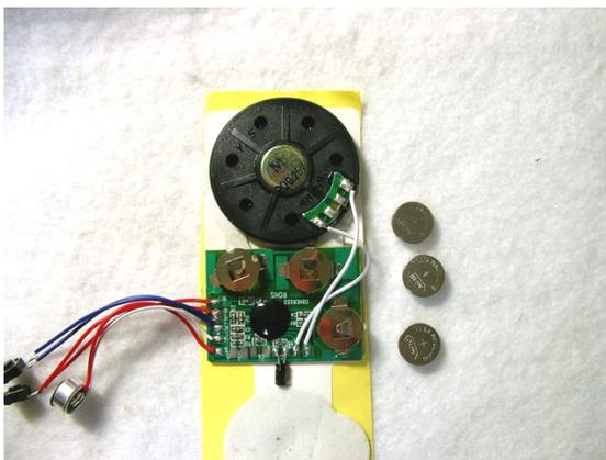
2. ボタン電池押さえ 1 個 (写真で左上) をニッパーで切り取るか、ハンダゴテで取り外す。その下のパターンが電池のマイナス。
