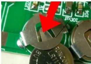
接触不良やボタン電池がはずれやすい場合はこの板バネを押ししてください。注意:接触不良の場合は動作しません。
