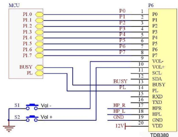
**シリアルモード:** 端子はロジックレベルですので、RS232C 機器とのシリアル通信には、レベル変換が必要です(たとえば MAX232 レベルコンバータ IC など)。
