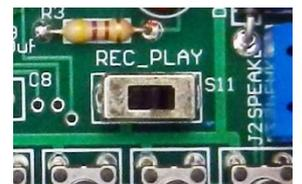
**再生する:**スライドスイッチ S11 を PLAY 側にスライドさせ、押しボタンスイッチ(タクトスイッチ) S1 から S8 の 8 個のうち任意のスイッチを押す(スイッチ数は録音再生数に依存)と約 1 秒後に LED が点灯し、そのスイッチに対して録音された音声再生されます。再生中は LED が点灯します。(注意:再生中に再度再生スイッチを押すと停止します。再生スイッチを押している間は繰り返し再生します)
