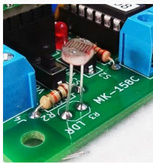
←LDRを浮かしてハンダ付け
