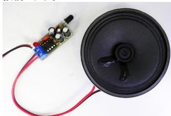
**音源接続:** 3.5mm径のステレオプラグの右チャンネル(リング部)とスリーブ部でラジオなどのスピーカー出力またはイヤホンジャック出力を送信機のステレオジャックコネクタに接続します。先端のチップ部は使用しません。**注意:モノラルプラグは使用できません。**
