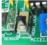
構)、約1G(約90度)よりも低い傾き(加速度)になると、リレーがオフとなり、COM端子とNO端子が開放され、逆にCOM端子とNC端子が再度接続されます。
