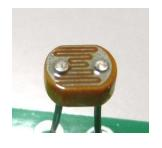
抗値がもっとも小さくなります。ぜひ、組み立てる前に抵抗が測定できるテスターを使用してお確かめください。まず、部品表に記載されている部品がすべて入っているかお確かめください。次に、背の低い部品からハンダ付けしてください。抵抗、ダイオード、の順にまずハンダ付けします。次にスライドスイッチ、半固定ボリューム、LEDの順にハンダ付けしてください。光センサーのリード線は10mm程度にしてハンダ付けすればボードに対してセンサーを横に向けることもできます。設置する場所にあわせてセンサーの向きを決めてください。電源端子、リレーの出力端子としてターミナルブロック(ネジ式端子)を2個(2極(足が2本)と3極(足が3本))使用しています。重要:ハンダ付けする前に必ず2つのターミナルブロックをスライドさせてくつつけてください(写真。どちらが右または左
