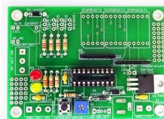
◆トランジスタ4個と電解コンデンサー1個を実装する
