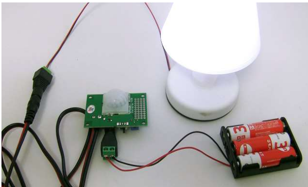
<写真:電源コネクタのないLEDランプと電池ボックスの接続例>
