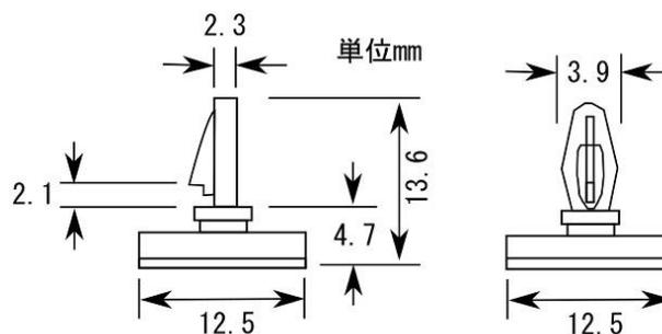
対応する基板: 穴径3.2mm-3.5mm、板厚1.6mm
