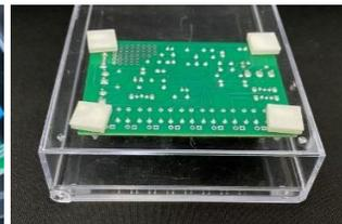
4. プリント基板を取りはずす: 斜めに飛び出た「かえし」を小型のマイナスインドライバーなどで押しながら、プリント基板を引き抜きます。
